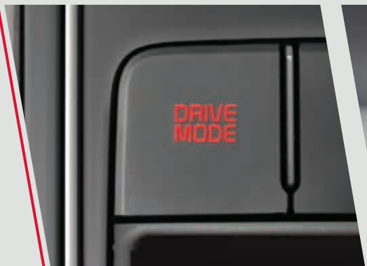
Sistema de condução Drive Mode, com as opções Normal/Eco/Sport/Smart
