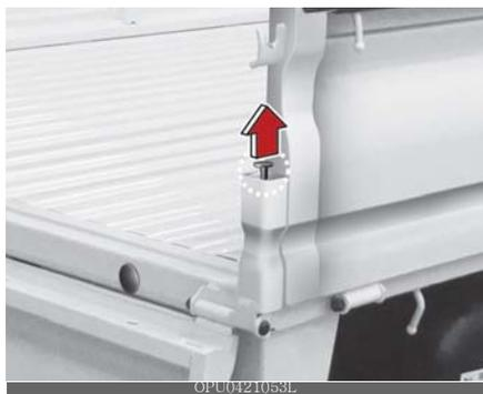
2. Remova a maçaneta da guarda lateral do gancho depois de puxá-la para cima.
