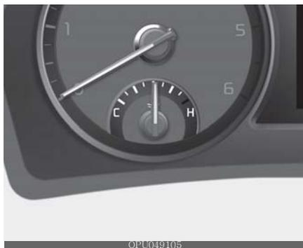
Este medidor indica a temperatura do líquido de arrefecimento do motor quando a chave de ignição estiver ligada.
