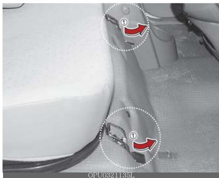
3. Levante o assento e trave a correia de fixação na âncora abaixo do assento do passageiro para prender o assento. Use cada moldura na alça para ajustar o ângulo ao levantar o assento.
