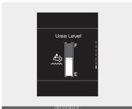
O medidor de nível de solução de ureia indica a quantidade aproximada de solução de ureia restante dentro do tanque de solução de ureia.
