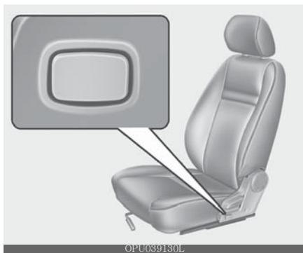
O apoio lombar pode ser ajustado pressionando o interruptor do apoio lombar na lateral do assento.
