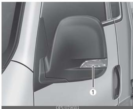
Se a luz repetidora lateral (tipo LED) (1) não funcionar, mande verificar o seu veículo em uma Concessionária Autorizada Kia.
