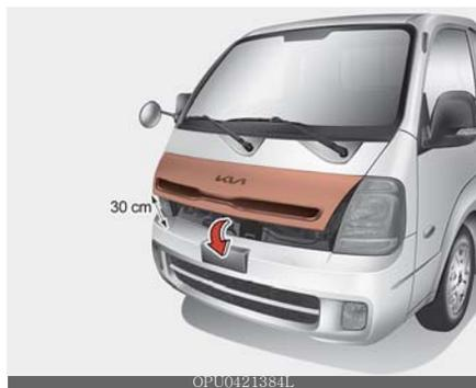
4. Verifique se o capô está bem encaixado. Se o capô puder ser levantado ligeiramente, ele não está encaixado corretamente. Abra-o novamente e feche-o com um pouco mais de força.
