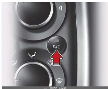
Pressione o botão A/C para ligar o sistema de ar condicionado (a luz indicadora acenderá). Pressione o botão novamente para desligar o sistema de ar condicionado.
