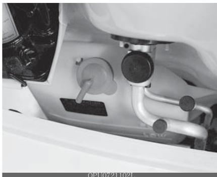
Verifique a condição e as conexões de todas as mangueiras do sistema de arrefecimento e mangueiras do aquecedor. Substitua quaisquer mangueiras inchadas ou deterioradas.
