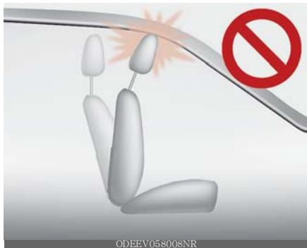
Se você reclinar o encosto do banco para a frente com o encosto de cabeça e o assento do banco levantados, o encosto de cabeça pode entrar em contato com o para-sol ou outras partes do veículo.
