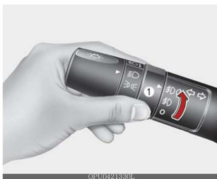
Acender o Farol de neblina traseiro, é possível quando o farol estiver LIGADO ou na condição Farol de neblina dianteiro e luz de posição (luz traseira) LIGADOS, girando o interruptor do Farol de neblina traseiro (1) para a posição LIGADO.
