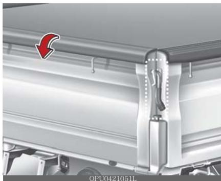
1. Levante a maçaneta da guarda traseira, empurre-a para dentro e puxe-a em sua direção.
