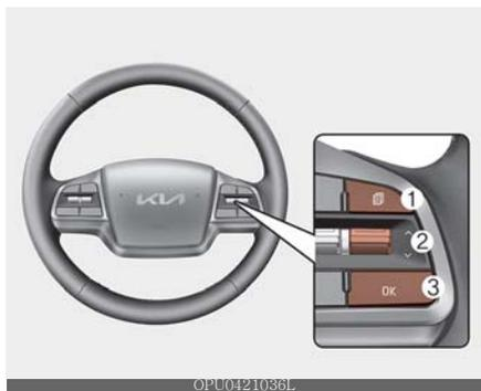
Os modos de exibição LCD podem ser alterados usando os botões de controle no volante.
