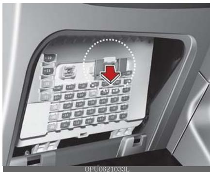
O seu veículo está equipado com um fusível de memória (1) para evitar o descarregamento da bateria se o veículo ficar estacionado sem ser utilizado durante períodos prolongados.
