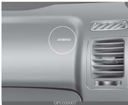
O SRS consiste em airbags instalados sob as tampas das almofadas no centro do volante e no painel frontal do passageiro acima do porta-luvas.
