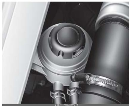
Com o veículo em terreno plano, verifique periodicamente o nível do fluido no reservatório da direção hidráulica. O fluido deve estar entre as marcas MAX e MIN na lateral do reservatório na temperatura normal.
