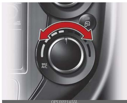
O botão de controle de temperatura permite controlar a temperatura do ar que sai do sistema de ventilação. Para alterar a temperatura do ar no habitáculo, gire o botão para a direita para ar quente ou para a esquerda para ar mais frio.
