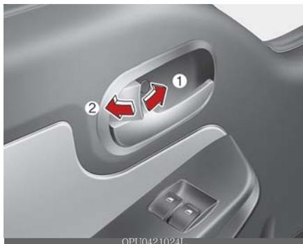
Se você travar (1)/destravar (2) a porta do motorista ou a porta do passageiro (se equipado) com uma chave ou botão de travamento da porta, as portas dianteiras serão travadas/destravadas automaticamente.
