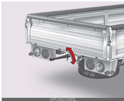
1. Insira a chave de roda no suporte do pneu sobressalente e insira a alavanca da chave na chave de roda.
