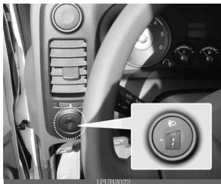
Para ajustar o nível do farol de acordo com o número de passageiros e o peso da carga, gire o interruptor de nivelamento do farol.
