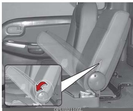
Para usá-lo como uma caixa de console, empurre para baixo a alavanca de liberação ao lado do banco e dobre o encosto do banco para frente (pode ser necessária a remoção do apoio de cabeça para uma melhor acomodação).
