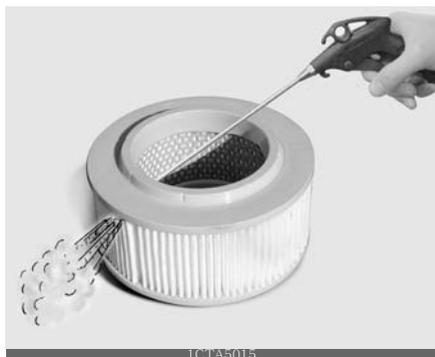
O elemento do filtro de ar pode ser limpo com ar ou substituído, dependendo de sua condição. A menos que esteja muito sujo, apenas agite-o para remover partículas estranhas. Cada vez que este filtro for inspecionado, limpe o interior da carcaça do filtro de ar e cubra com um pano úmido. Se o veículo for operado em áreas extremamente empoeiradas ou arenosas, limpe ou substitua o elemento do filtro de ar com mais frequência do que nos intervalos recomendados.
