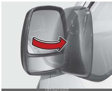
Para rebater o espelho retrovisor externo, segure a caixa do espelho e dobre-o em direção à parte traseira do veículo.
