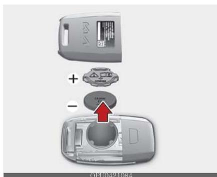
O transmissor usa uma bateria de lítio de 3 volts que normalmente dura vários anos. Quando a substituição for necessária, use o seguinte procedimento.
