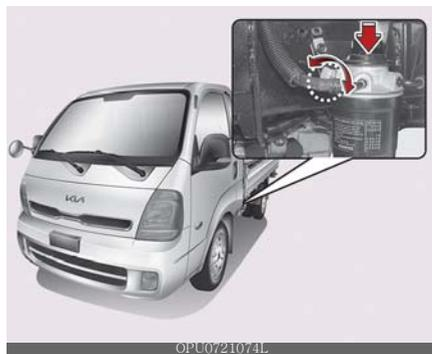
O sistema de combustível deve ser sagnado para remover o ar conforme descrito na ilustração se o suprimento de combustível acabar durante a viagem, quando o filtro de combustível for substituído ou se o veículo não for usado por um longo período.
