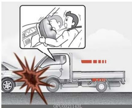
O airbag frontal foi projetado para insuflar em uma colisão frontal, dependendo da intensidade, velocidade ou ângulos de impacto da colisão frontal.
