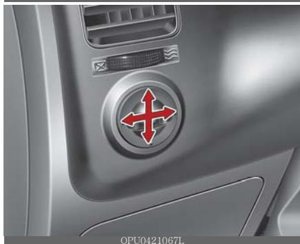
O interruptor do espelho do controle remoto elétrico permite ajustar a posição dos espelhos retrovisores externos esquerdo e direito. Para ajustar a posição de qualquer um dos espelhos, selecione o espelho do lado direito ou o espelho do lado esquerdo e, em seguida, pressione um ponto correspondente (●) no controle de ajuste do espelho para posicionar o espelho selecionado para cima, para baixo, para a esquerda ou para a direita.
