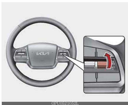
Se qualquer método diferente do botão CRUISE for usado para cancelar a velocidade de cruzeiro e a função ainda estiver ativada, a velocidade definida mais recente será retomada automaticamente quando o botão RES+ for pressionado.
