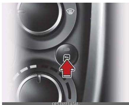
É usado para selecionar a posição do ar externo (fresco) ou a posição do ar recirculado. Para alterar a posição do controle de admissão de ar, pressione o botão de controle.
