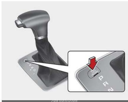
Se a bateria estiver descarregada ou a ignição não estiver ligada, a alavanca de câmbio não se moverá da posição P (estacionamento) para a posição R (ré) mesmo quando o pedal do freio estiver pressionado. Neste caso, enquanto pressiona o botão de liberação da alavanca de câmbio na frente da alavanca de câmbio, pressione o botão da alavanca de câmbio para mover a alavanca de câmbio, você pode mudar para outra posição.
