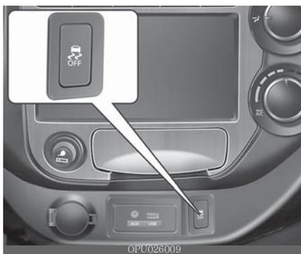
O sistema de Controle Eletrônico de Estabilidade (ESC) foi projetado para estabilizar o veículo durante as manobras nas curvas. O ESC verifica para onde você está dirigindo e para onde o veículo está realmente indo. O ESC aplica os freios em rodas individuais e intervém no sistema de gerenciamento do motor para estabilizar o veículo.
