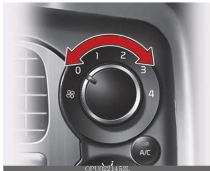
São fornecidas quatro (4) velocidades de ventilador ajustáveis que aumentam à medida que o número aumenta. O interruptor de ignição deve estar na posição ON (ligado) para o funcionamento do ventilador.
