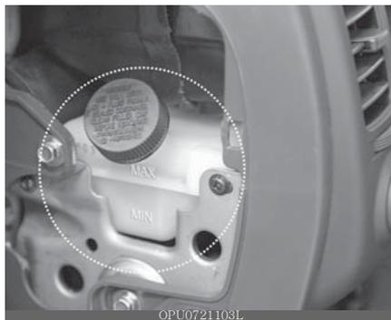
Verifique periodicamente o nível do fluido no reservatório. O nível do fluido deve estar entre as marcas MAX e MIN na lateral do reservatório.
