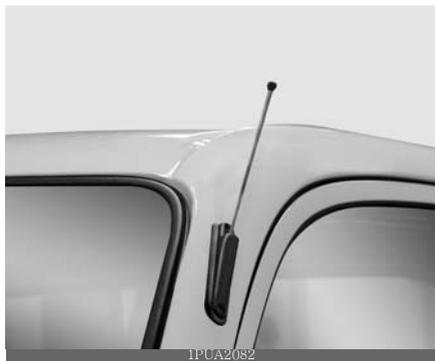
Seu veículo usa uma antena manual de aço inoxidável para receber sinais de transmissão AM e FM. Puxe a antena para cima usando os dedos.
